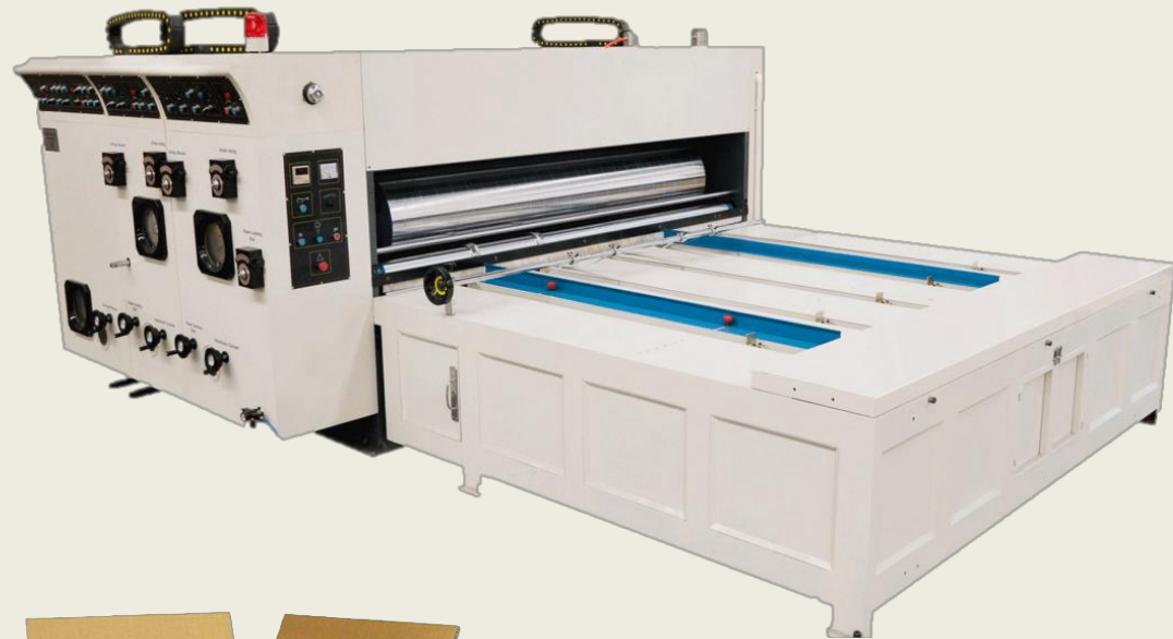
IMPRESORA FLEXOGRÁFICA 3 TINTAS 4000 CAJAS P/HORA
